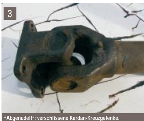
„Abgenudelt“: verschlissene Kardan-Kreuzgelenke.
