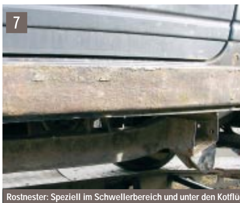
Rostnester: Speziell im Schwellerbereich und unter den Kotflügelverbreiterungen (Samurai) hat's die braune Pest.
