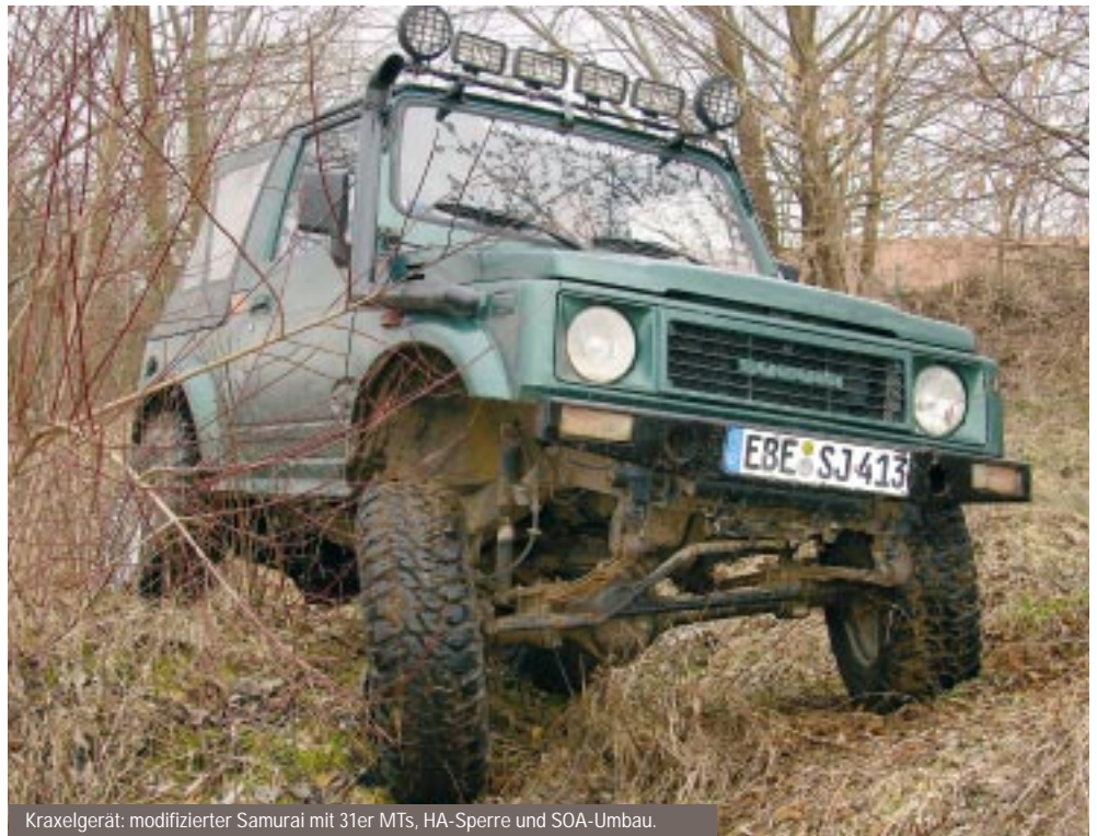
Kraxelgerät: modifizierter Samurai mit 31er MTs, HA-Sperre und SOA-Umbau.
