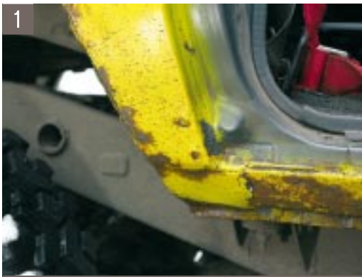
Ziemlich faul: im unteren Bereich rostanfällige B-Säule und Schweller.
