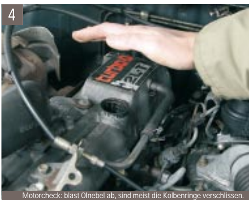
Motorcheck: bläst Ölnebel ab, sind meist die Kolbenringe verschlissen.
