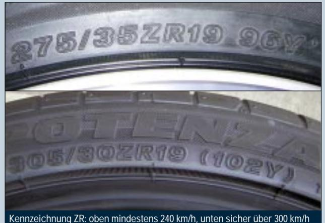
Kennzeichnung ZR: oben mindestens 240 km/h, unten sicher über 300 km/h
