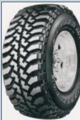
Der Bridgestone Dueler M/T 673 ist ein typischer M/T-Reifen: hoher Negativanteil für gute Selbstreinigung und Traktion. Außerdem ist seine Konstruktion resistent gegen eindringende spitze Gegenstände im Gelände
